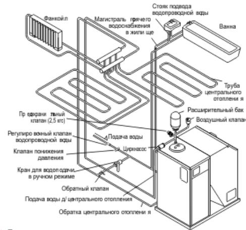
\* При монтаже предохранительного клапана убедитесь, что его давление отрегулировано на 2,5 кгс/см<sup>2</sup>, давление в системе не превышает 2 кгс/см<sup>2</sup>.
