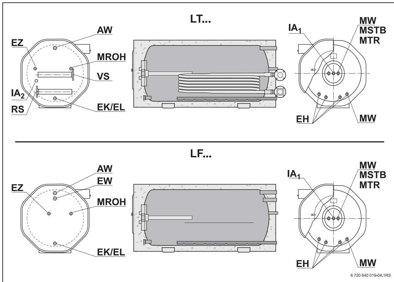
Рис. 1 Подключения LT/LF
