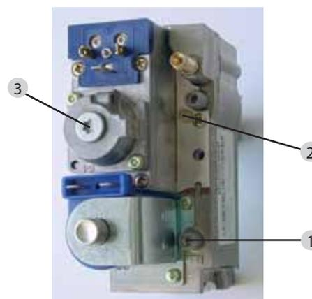
Отрегулируйте уровень CO<sub>2</sub>, поворачивая винт дросселя (2). В зависимости от положения дросселя, поверните винт либо по часовой стрелке, либо против часовой стрелки, чтобы повысить или понизить уровень CO<sub>2</sub>. Настройка давления газа (3) устанавливается на заводе-изготовителе и не подлежит изменению при монтаже.
