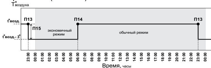
Рис.5 График температуры воздуха в помещении для Режим 2.
